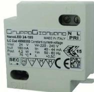
afb. 3 Voedingsapparaat 230 Vac - 24 Vdc
